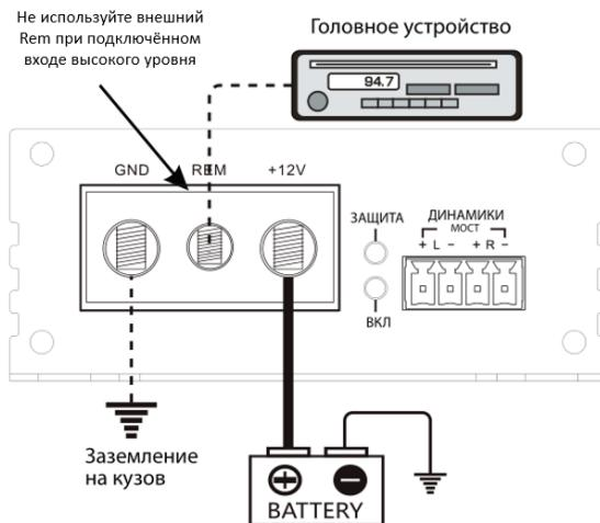
**+12V:** Для надежной работы усилителя требуется использовать провод сечение которого соответствует максимальному току потребления усилителя, не ниже 80А.
