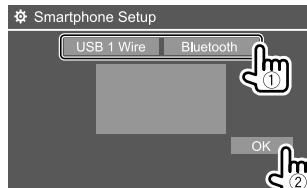
**[USB 1 Wire]** Выбирайте эту опцию, когда устройство подсоединенено через входной разъем USB (кабеле от задней панели).
