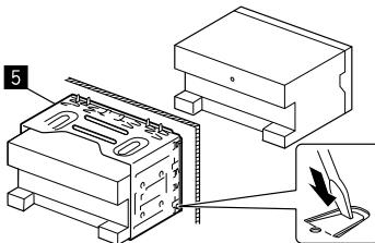
Согните щипцы монтажной муфты с помощью отвертки или аналогичного инструмента и установите ее на место.
