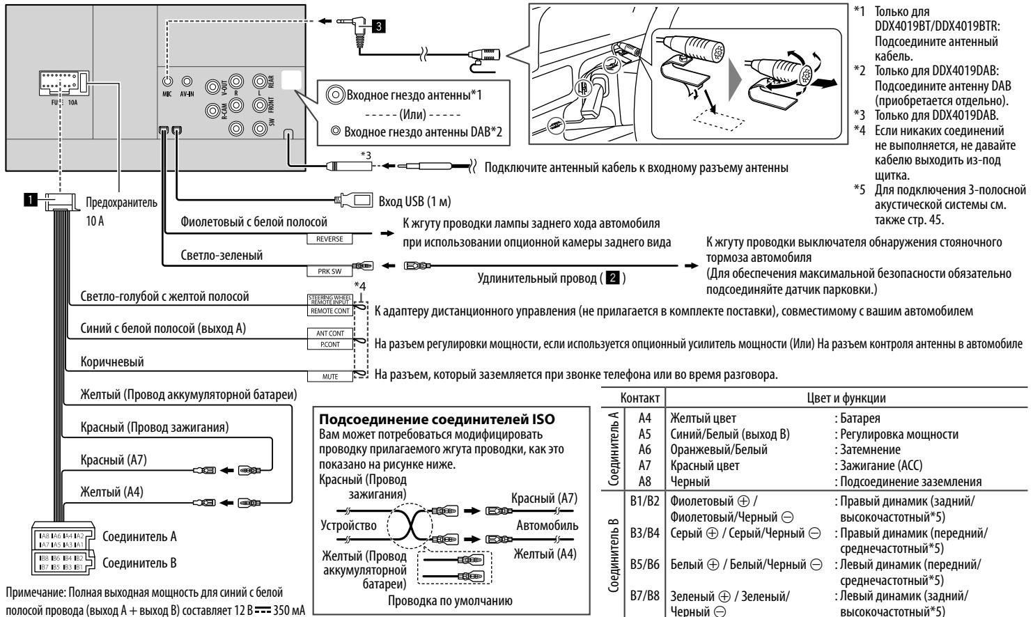
Примечание: Полная выходная мощность для синий с белой полосой провода (выход А + выход В) составляет 12 В = 350 мА
